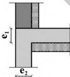
ضرایب انتقال حرارت خطی  $\Psi$  اتصال دیوار بتنی با عایق از داخل به کف با عایق از خارج بستگی به ضخامت کف  $e_1$  و ضخامت دیوار  $e_2$  دارد و با مقادیر جدول پ ۱۱-۸ تعیین می‌گردد.
