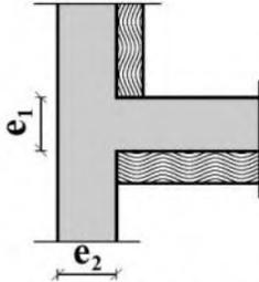
ضرایب انتقال حرارت خطی  $\Psi$  اتصال دیوار بتنی با عایق از داخل به کف با عایق از خارج بستگی به ضخامت کف  $e_1$  و ضخامت دیوار  $e_2$  دارد و با مقادیر جدول پ ۱۱-۷ تعیین می‌گردد.
