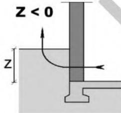
ضرایب انتقال حرارت خطی  $\Psi$  دیوار مجاور خاک، بسته به عمق زیرزمین و ضریب انتقال حرارت سطحی دیوار، با استفاده از جدول پ ۱۱-۶، تعیین می‌گردد.
