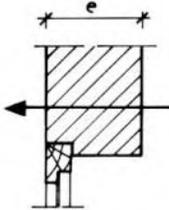
ضرایب انتقال حرارت خطی  $\Psi$  اتصال بازشوهای همباد خارج به جدارهای غیرنورگذر (دیوارهای خارجی) به ضخامت جدار  $e$  بستگی دارد و با مقادیر جدول پ ۱۱-۱۲ تعیین می‌گردد.
