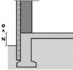
در صورت ادامه یافتن عایق حرارتی از خارج، تا روی شالوده، ضریب انتقال حرارت خطی، بسته به مقاومت عایق حرارتی و اختلاف تراز داخل و خارج، با استفاده از مقادیر جدول پ ۱۱-۳ و کسر مقادیر ارائه شده در جدول پ ۱۱-۵، به دست می‌آید.
