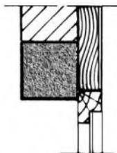
ضرایب انتقال حرارت خطی  $\Psi$  اتصال بازشوهای همباد با عایق حرارتی دیوار خارجی (به ضخامت جدار  $e$ ) برابر صفر در نظر گرفته می‌شود.
