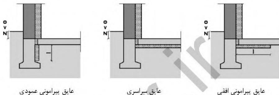
شکل پ ۱۱-۴ حالات مختلف عایق کاری حرارتی کف روی خاک به صورت کاهش یافته
