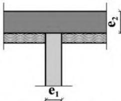
شکل پ ۱۱-۱۲ اتصال دیوارهای داخلی و خارجی
